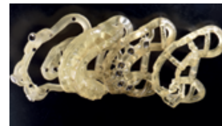
Exemple d'aligneur réalisé sur modèle imprimé par stéréolithographie.
